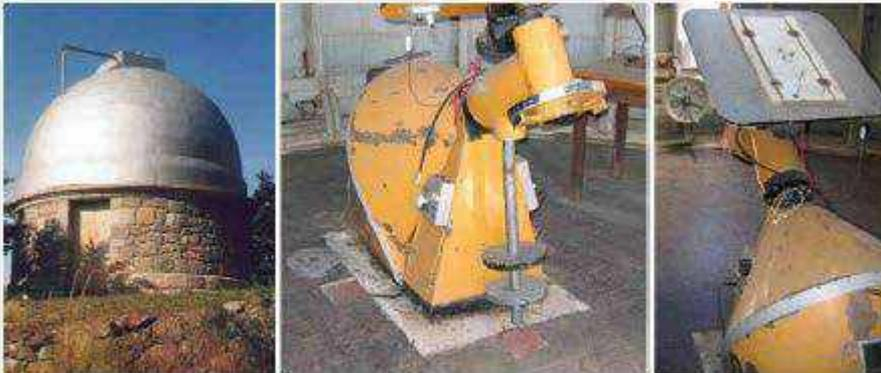
La vieja montura original del telescopio fue adaptada para una "tabla" ecuatorial multiuso, instalada en la cúpula chica de la Estación Astrofísica de Bosque Alegre (Edgardo Pizarro 2010). Izquierda: cúpula chica de la Estación Astrofísica de Bosque Alegre, centro y derecha: vistas de la tabla ecuatorial.
