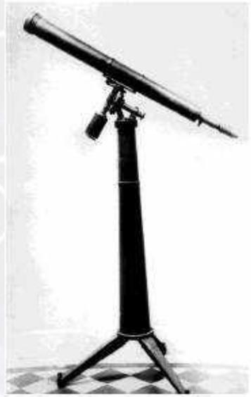
Telescopio refractor con montura ecuatorial portátil, con objetivo 125mm de diámetro fabricado por Alvan Clark & Sons, con el que se realizó la Córdoba Durchmusterung.
